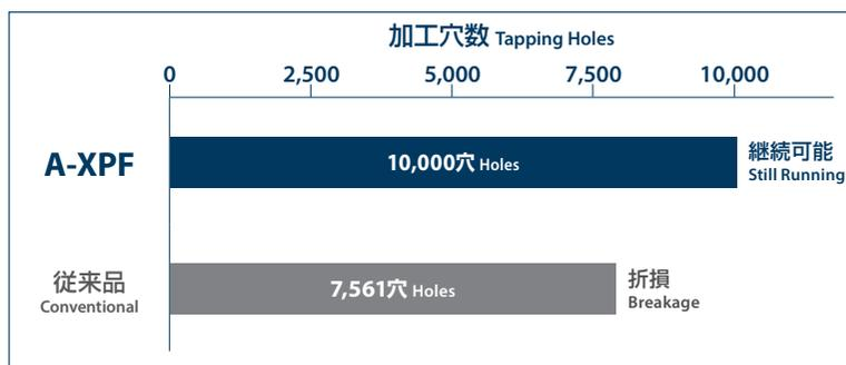
マルテンサイト系ステンレス鋼の小径ねじ加工でも抜群の耐久性
